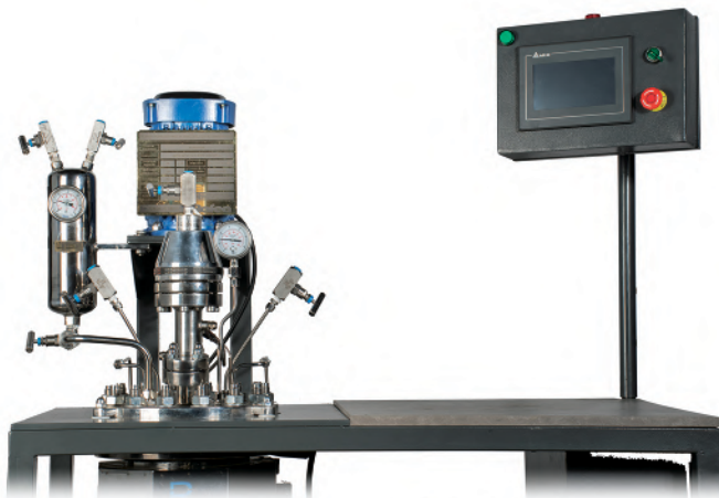
راکتور ۱۰ لیتری با فشار ۴۰ بار و دمای ۲۵۰ درجه سانتیگراد با کوپلینگ مغناطیسی قابل شستشو
